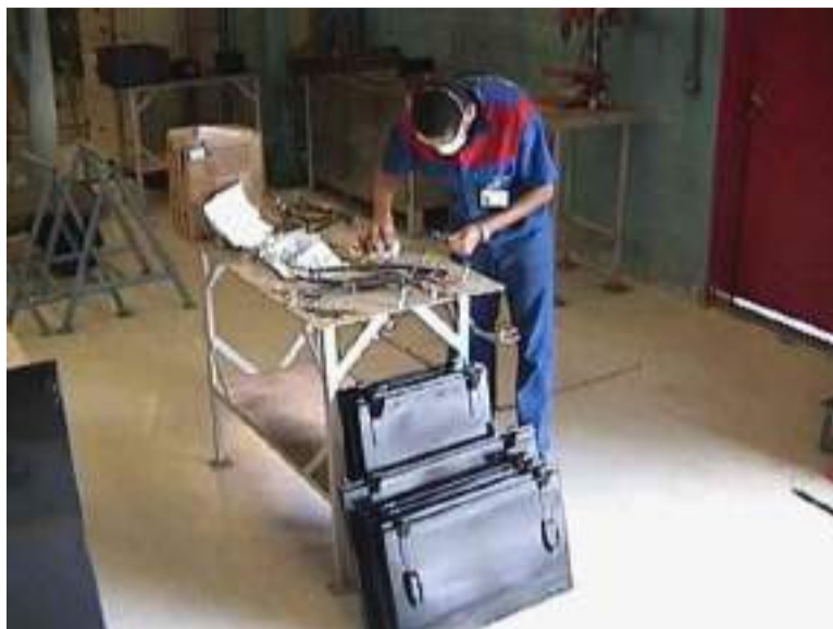
Foto 02: Bancada de trabalho para estancar contatos eletromecânicos: O operário flexiona toda a coluna para obter alcance dos contatos, pois a bancada é muito baixa (Estatura do operário = 1,90 m).
